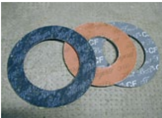
Dichtungen aus fest gebundenen Asbestfasern (Quelle: IST)
