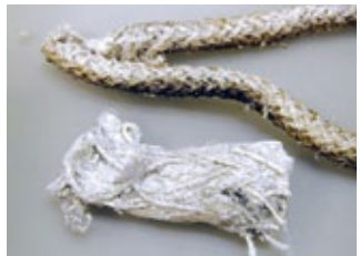
Dichtungsschnüre aus reinen Asbestfasern (Quelle: IST)
